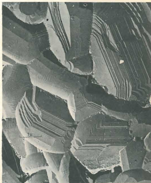
Ferroxdure: ingrandimento 24.000. Il ferroxdure è un materiale magnetico-ceramico che va sostituendosi sempre di più ai convenzionali magneti permanenti in acciaio.
