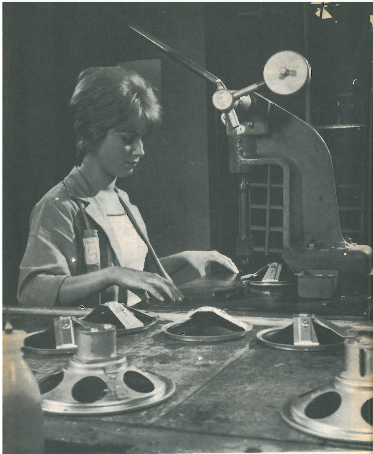
Montaggio del magnete permanente, costituito dal nuovo materiale magnetico ceramico chiamato Ferroxdure, su alcuni tipi di altoparlanti.
